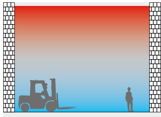
Funktionsprinzip der Luftenschichtung Funktionsprinzip der Luftenschichtung
