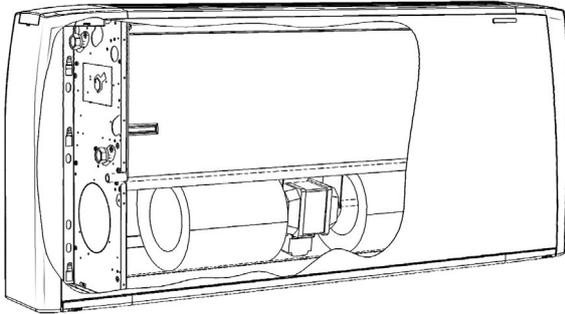
Das Modell DXC ECM ist in 5 Baugrößen erhältlich, mit oder wahlweise ohne Gehäuse. Das Gehäuse besteht aus feuerverzinktem, lackiertem Stahlblech in Weiß (RAL 9003). Die Seitenteile sind aus hochwertigem ABS Kunststoff in hellgrau (Pantone Cool Gray 1C) gefertigt. Die innere Verkleidung aus feuerverzinktem Stahl (1 mm) ist für die Schall- und Wärmedämmung mit Polyolefin-Schaum (Klasse M1) gefüllt.
