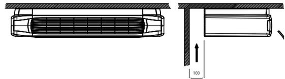
Die Ausführung kann horizontal installiert werden, wobei ein Abstand von mindestens 100 mm für die Luftaufnahme eingehalten werden muss.
