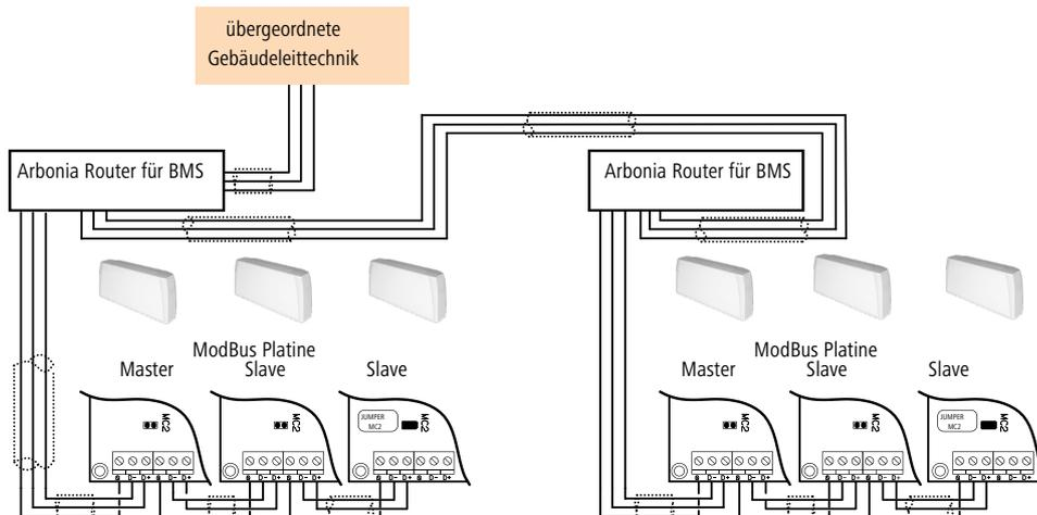
Anbindung der Fan Coils mittels 0 - 10 V Signalübertragung
