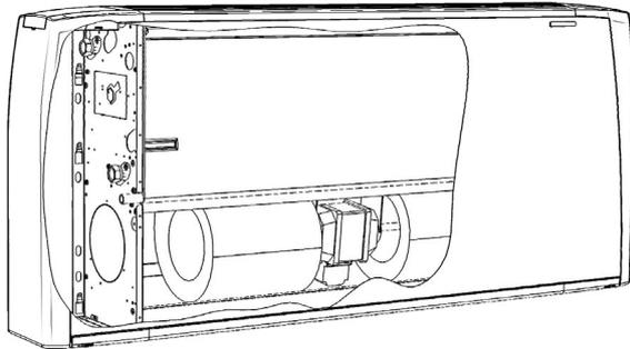
Das Modell DXC ist in 9 Baugrößen erhältlich, mit oder wahlweise ohne Gehäuse. Das Gehäuse besteht aus feuerverzinktem, lackiertem Stahlblech in Weiß (RAL 9003). Die Seitenteile sind aus hochwertigem ABS Kunststoff in hellgrau (Pantone Cool Gray 1C) gefertigt. Die innere Verkleidung aus feuerverzinktem Stahl (1 mm) ist für die Schall- und Wärmedämmung mit Polyolefin-Schaum (Klasse M1) gefüllt.
