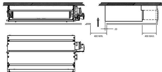
Für die beste Funktion der DXD IV Geräte dürfen keine Kanäle saugseitig montiert werden.
