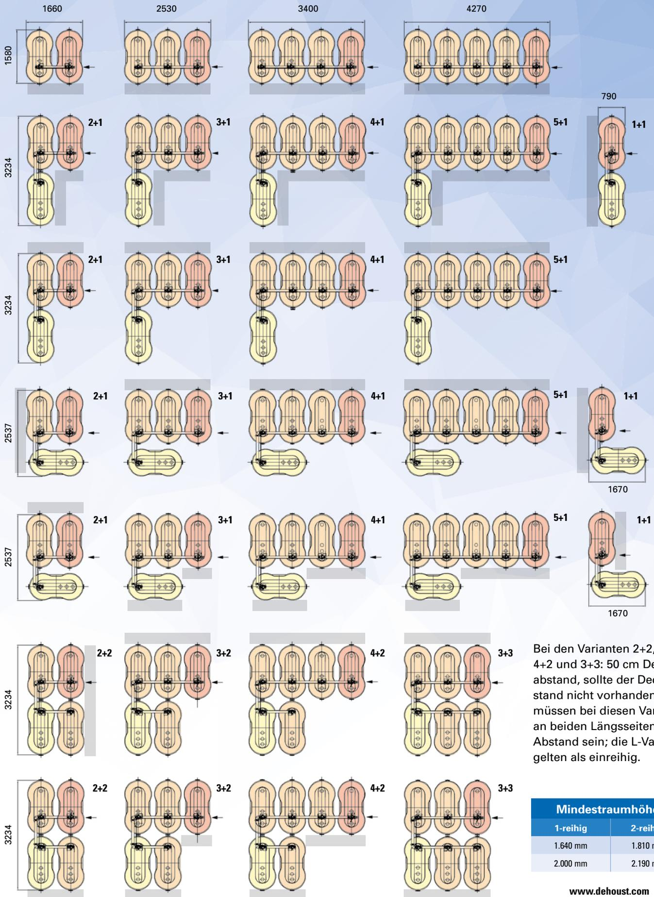
Bei den Varianten 2+2, 3+2, 4+2 und 3+3: 50 cm Deckenabstand, sollte der Deckenabstand nicht vorhanden sein, müssen bei diesen Varianten an beiden Längsseiten 40 cm Abstand sein; die L-Varianten gelten als einreihig.
