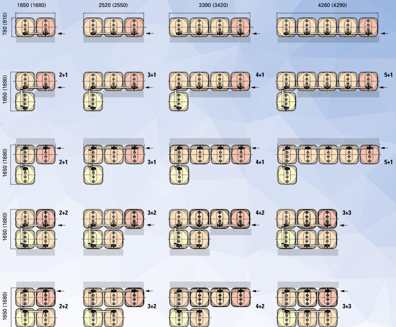
Bei den Varianten 2+2, 3+2, 4+2 und 3+3: 50 cm Deckenabstand, sollte der Deckenabstand nicht vorhanden sein, müssen bei diesen Varianten an beiden Längsseiten 40 cm Abstand sein; die L-Varianten gelten als einreihig.
