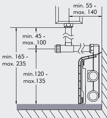
**Für die Anbindung des Heizkörperanschlusses mittels Ausgleich-, Winkel-Absperr- oder Passbogenverschraubung an den Heizkörper bieten wir verschiedene Alternativen auf den Seiten 34-35 an. Hierzu sind nur die von HZ gelieferten metallisch dichten Klemmringverschraubungen zugelassen. Weichdichten-Verschraubungen sind keinesfalls zulässig!**
