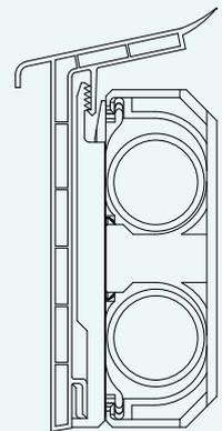
**SLT** Das Teppichbodenprofil mit starkem Selbstklebeband
