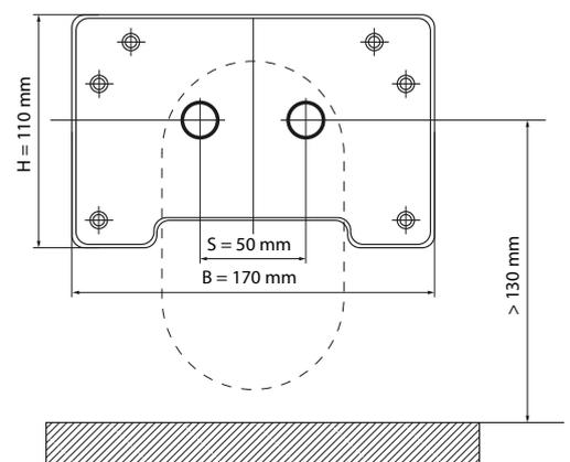
Lieferumfang: Anschlussbögen inkl. Abdeckblende mit 2 Schrauben und Dübel
