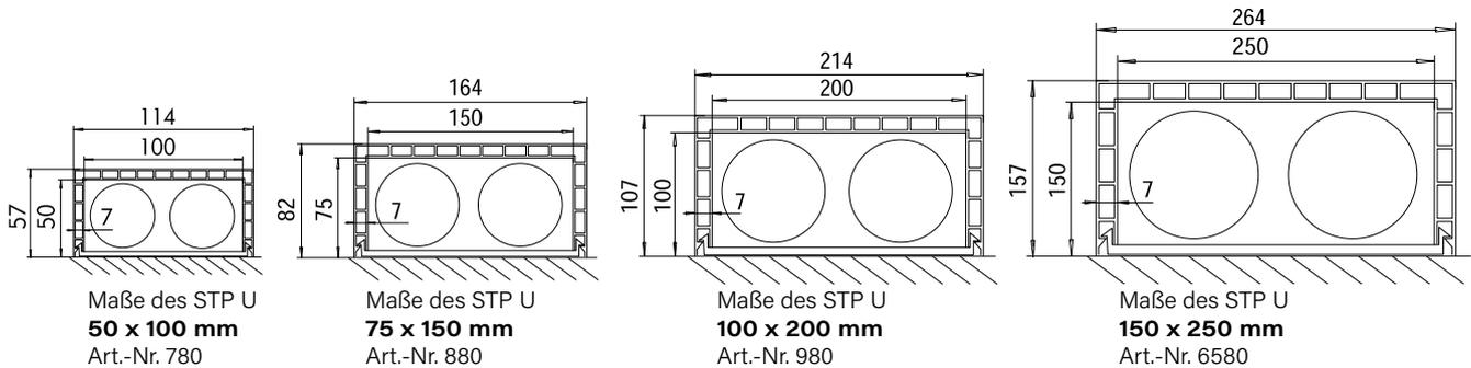
Die HZ Steigstrangprofile in U-Form sind stabile Kunststoffhohlkammerprofile, die weiß durchgefärbt sind (ähnlich RAL 9010). Sie sind zwei oder drei Meter lang und in vier verschiedenen Abmessungen erhältlich.
