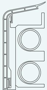
Bei Wänden und Böden mit größeren Unebenheiten empfehlen wir die Verwendung einer zusätzlichen Dichtlippe. Diese kann sowohl zur Wand als auch zum Fußboden hin auf die Sockelleiste aufgeklebt werden. Hiermit wird eine Verlängerung des Profiles bis zu 10 mm erreicht. Die Dichtlippe und andere Zubehörteile für die Sockelleisten finden Sie auf Seite 38.
