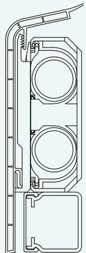
**SLL** Das ideale Profil für den Einsatz eines Kabelkanals oder eines dritten Rohres bis 20 mm
